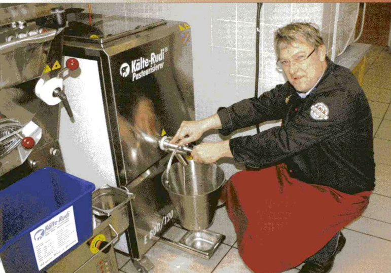
Guido Schmitz, Produktmanager Eis bei Kessco, entnimmt aus dem Pasteurisator des Herstellers Kälte Rudi die Eisgrundmasse und demonstriert die anschließende Eisherstellung bis zu den fertigen Eissorten in der Vitrine (links im Bild).
